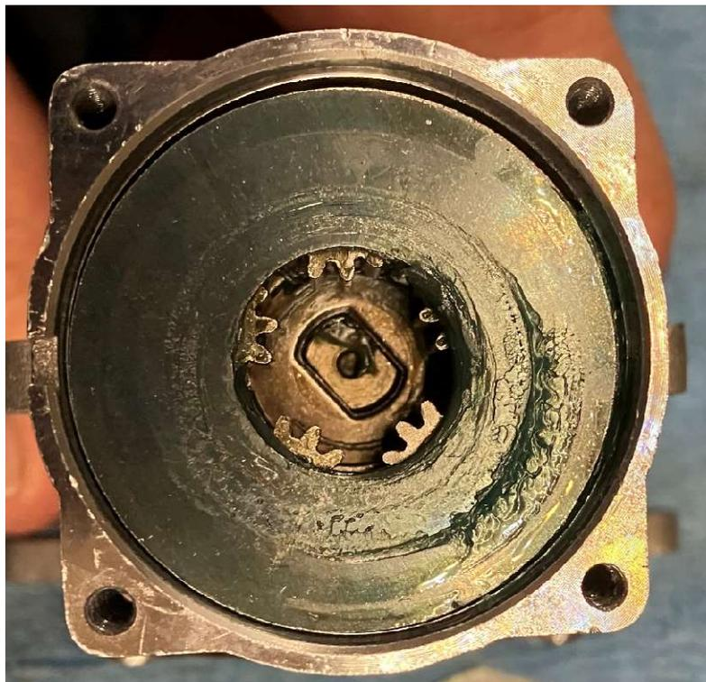
**STAGE-3 INSTALL PLASTIC GEAR BODY-NOTE IMAGE SHOWS NEXT STAGE COMPLETE**
